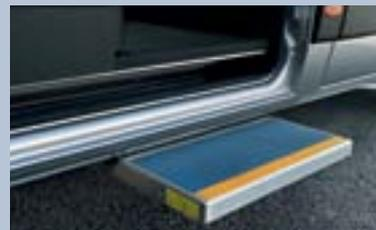
**Marche-pied latéral rétractable sur Bus.** De série, il se déploie et se rétracte électriquement. Il est couplé à une rampe d'accès pour faciliter la montée et la descente des passagers.
