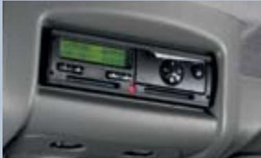
**Tachygraphe numérique.** Simple d'utilisation pour le conducteur. Enregistre fidèlement le temps de conduite et de repos à des fins de regroupement et d'analyse des données de gestion de parc automobile (de série sur version Bus).
