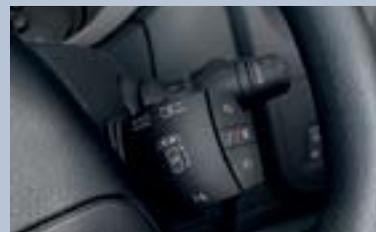
**Commandes de la radio au volant.** Permet d'éviter toute distraction au conducteur, en pilotant depuis le volant le système multimedia.
