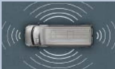
**Système d'alarme.** Alarme anti-vol avec commande à distance, équipée de détecteurs de mouvements volumétriques pour l'ensemble du véhicule (cabine et espace passagers) et d'une protection du compartiment moteur.
